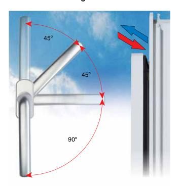
Diese SYMPHONY-Fenstergriff-Ausführung rastet zusätzlich bei der 45° Griff-Stellung ein. Kippstellung beträgt ca. 10 bis 13 mm. Die optimale Funktion der MACO-Sparlüftungsschere ist dadurch sichergestellt. Sperrbare Griffe auch mit 45°-Raste.
